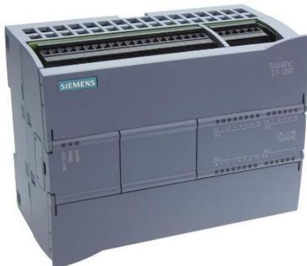
主控系统采用 S7-1200 系列 PLC，使用博途软件进行编程，通过工业以太网通信配合工业机器人完成外围控制任务。
