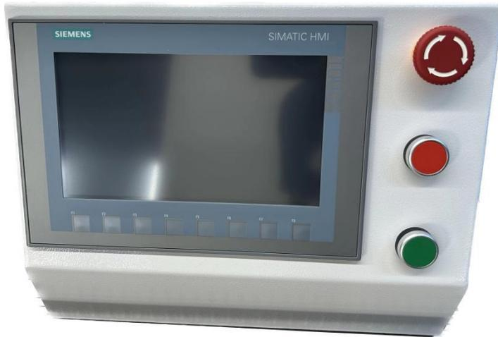
人机交互系统包含触摸屏和按钮指示灯，其中按钮指示灯具有设备开关机，电源状态指示，设备急停等功能，触摸屏选用西门子 ktp900 面板，用于设备的数据监控操作。
