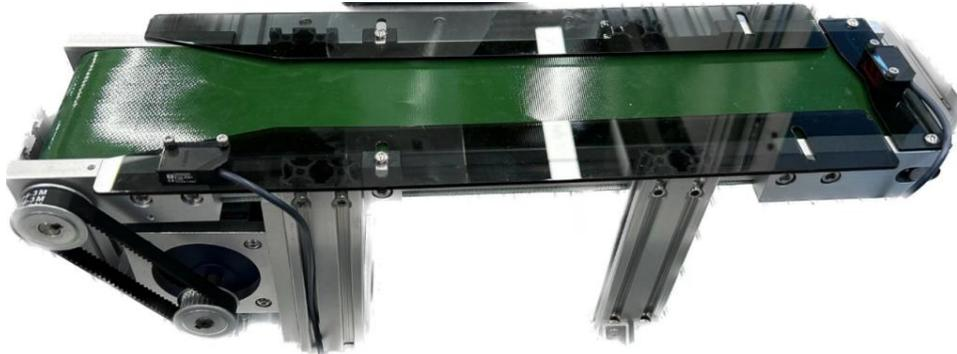
由铝合金框架、三相异步电机、传送带及安装底座组成，完成工件的输送任务，可与井式供料模块及视觉检测模块配合使用，共同完成中间法兰和输出法兰的落料、传输及检测等任务。
