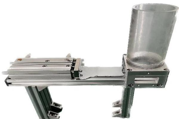
由推料装置、井式落料装置、安装底板及检测传感器组成，完成中间法兰和输出法兰自动落料及推料。
