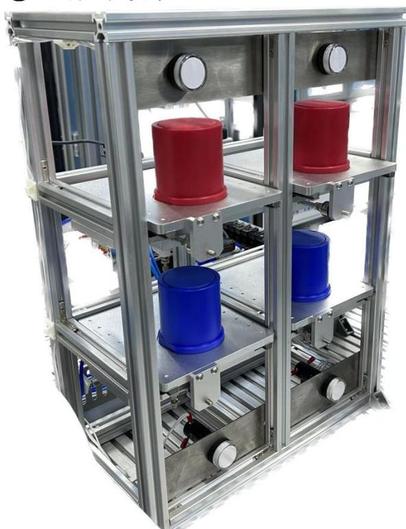
立体模块由关节套件，气缸、光电传感器等组成，可配合搬运模块、旋转供料模块、装配模块完成多种教学任务。
